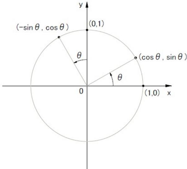
図6 回転変換行列を見付けるための図
